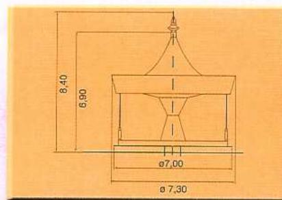
Toutes les structures métalliques sont galvanisées à chaud. Les sujets et les décors polyester sont décorés minutieusement à la main. Le plancher est en bois massif et les barres torsadées sont en aluminium anodisé ou en laiton.
